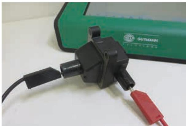
Per misurare la bobina secondaria misurare i picchi di prova direttamente sulle uscite dell'alta tensione della bobina di accensione.
